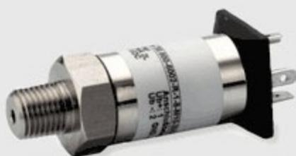
Экономичный датчик давления DMP 330F был специально разработан для применения в сфере жилищно-коммунального хозяйства, где нужны недорогие, надёжные и точные датчики. Датчик обеспечивает пропорциональное преобразование давления рабочей среды в электрический сигнал 4...20 mA с погрешностью 0,5% от диапазона измерения. Корпус датчика изготовлен из нержавеющей стали.
